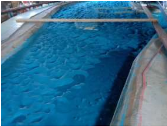
附图6 动床模型15年末松滋口分流口门处
