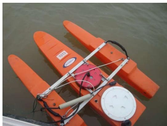
附图 I 固定在采样船上的声学多普勒流速仪
